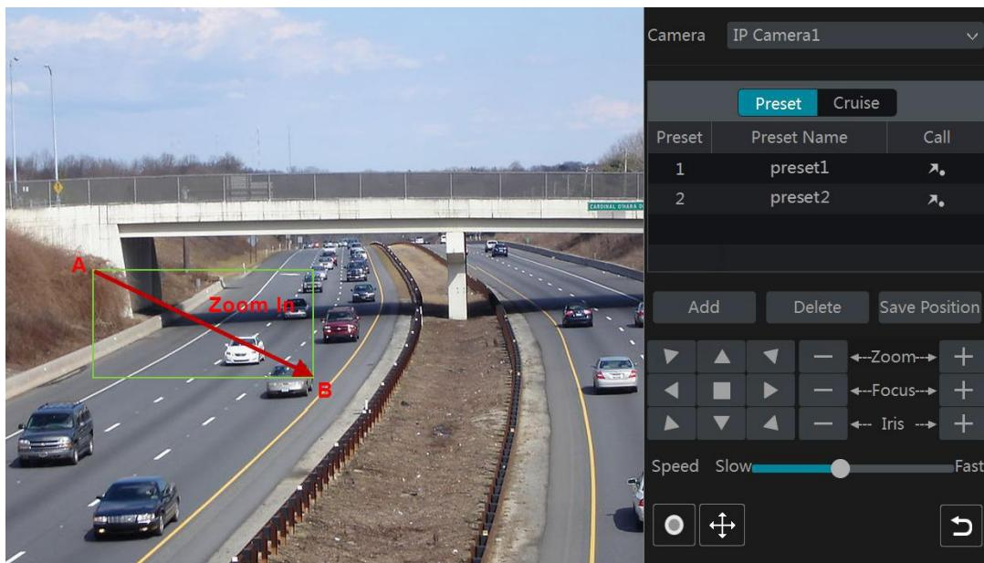
Kao što je prikazano na slici niže; odvucite mišem sa točke C na točku D kako bi se pojavio zeleni pravokutnik; slika će se umanjiti da bi prikazala područje unutar zelenog pravokutnika.
