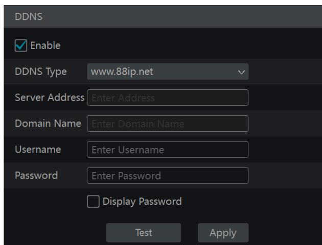
Označite „Enable“ i onda odaberite tip DDNS-a. Unesite adresu poslužitelja, ime domene, korisničko ime i zaporku prema odabranom DDNS tipu. Kliknite „Test“ kako bi testirali učinkovitost unesenih podataka. Kliknite „Apply“ za spremanje postavki.
