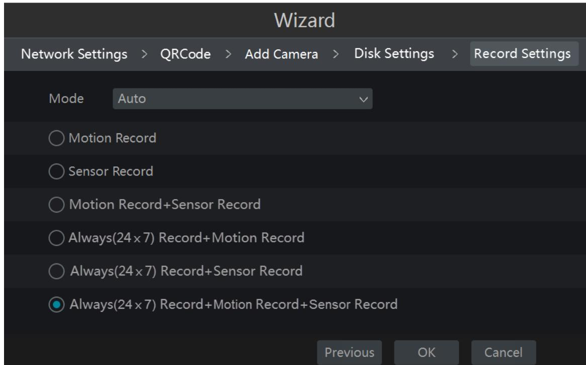
**Manual(vlastoručno):** Postavite „Sensor Record“ (snimanje po senzoru), „Motion Record“ (snimanje po detekciji pokreta) i „Schedule Record“ (snimanje po rasporedu) za svaku kameru. Kliknite „OK“ za spremanje postavki.
