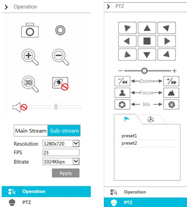
Kliknite na jedan prozor kamere u području pregleda te potom kliknite **Main Stream** kako bi postavili protok pregleda uživo te protok snimanja na glavni protok u vlastoručnom načinu snimanja; kliknite **Sub-stream** kako bi postavili protok pregleda uživo te protok snimanja na pod-protok. U kartici pod-protoka postavite rezoluciju, FPS i bitrate te potom kliknite „Apply“ kako bi spremili postavke.
