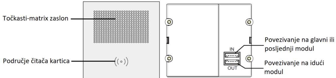
**Točkasti-matrix:** 16 x 24 točkasti matrix zaslon.
